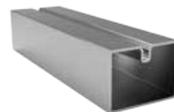
Hliníkový profil pre konštrukcie s podpernými bodmi každých 50 cm alebo konštrukcie pre pokládku na rovnom podklade 30 x 40 mm, max. 50 cm
